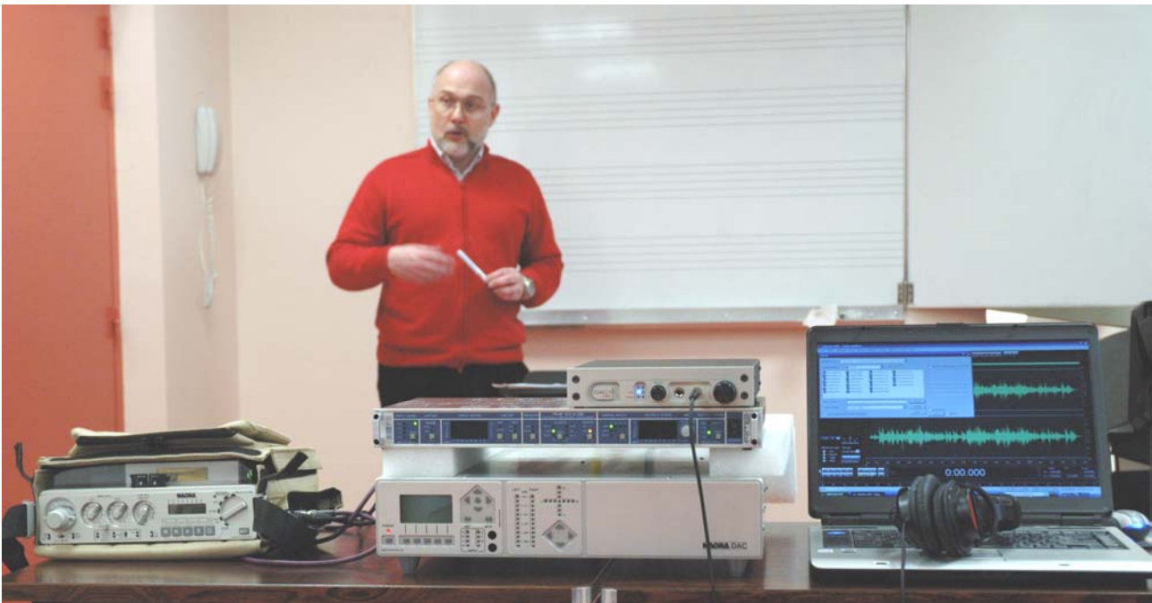
Les appareils en écoute: de gauche à droite, le Nagra V, le Nagra DAC avec, posé sur lui le RME et le Benchmark, et enfin l'ordinateur Toshiba lisant les fichiers WAV avec le logiciel Adobe Audition
